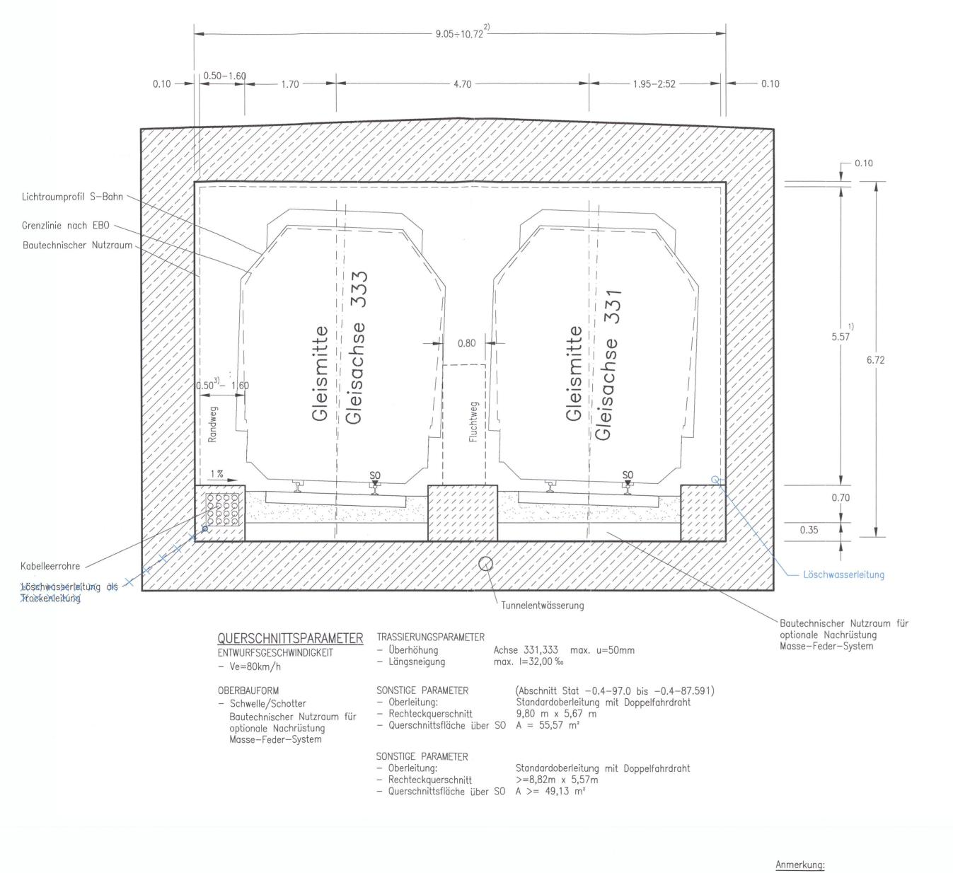
In diesem Querschnitt wird voraussichtlich eine Nachspannung erforderlich. Eine entgültige Aussage kann aber erst nach einer gesamten oberleitungs—technischen Planung getroffen werden.
