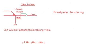
Anmerkung: Die genaue Lage der Streckentrennungen kann erst dann angegeben werden, wenn die Standorte der Ein— bzw Ausfahrsignale bekannt sind. Streckentrennungen müssen immer unter Signaldeckung liegen.
