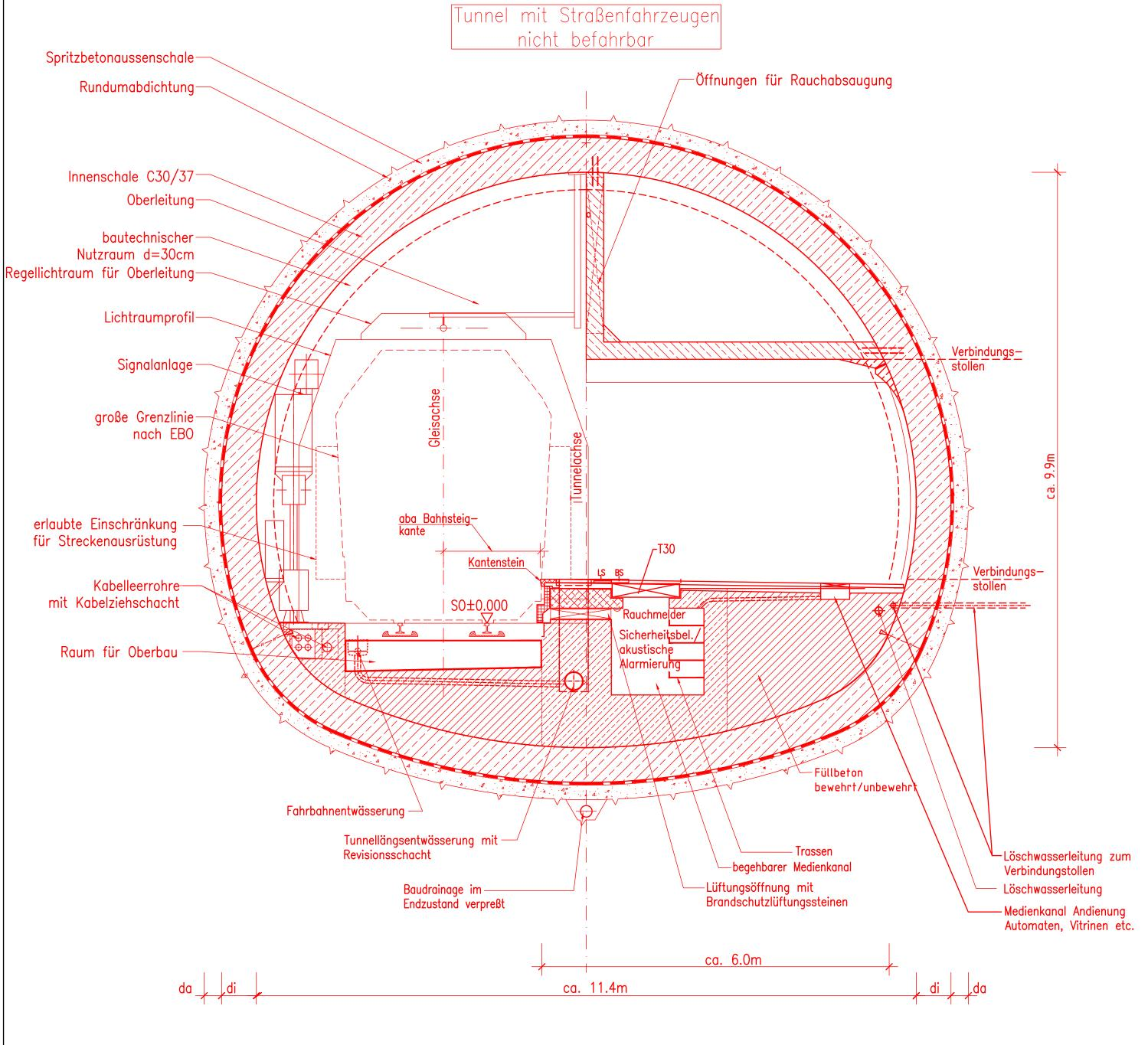
Querschnitt — Maulprofil mit Oberleitungssystem und Fester Fahrbahn
