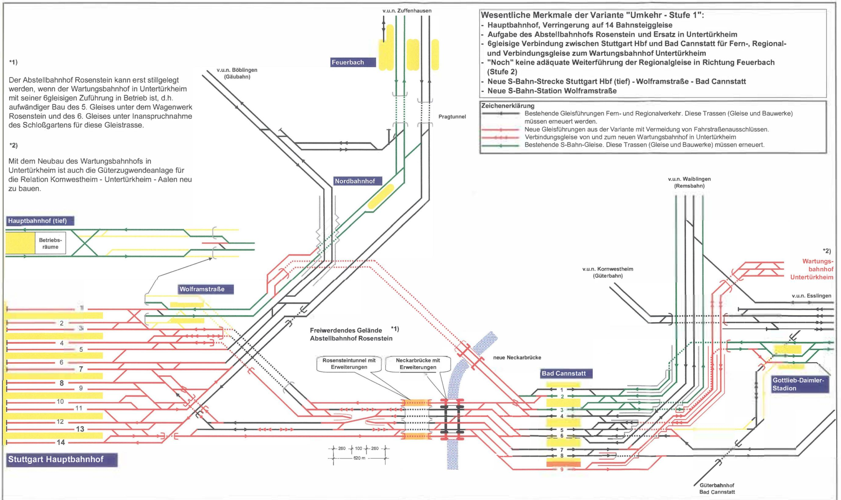
Variante "Umkehr - Stufe 1" mit Wbf Untertürkheim, ohne Ausbau in Richtung Feuerbach, jedoch unter Berücksichtigung Stufe 2
