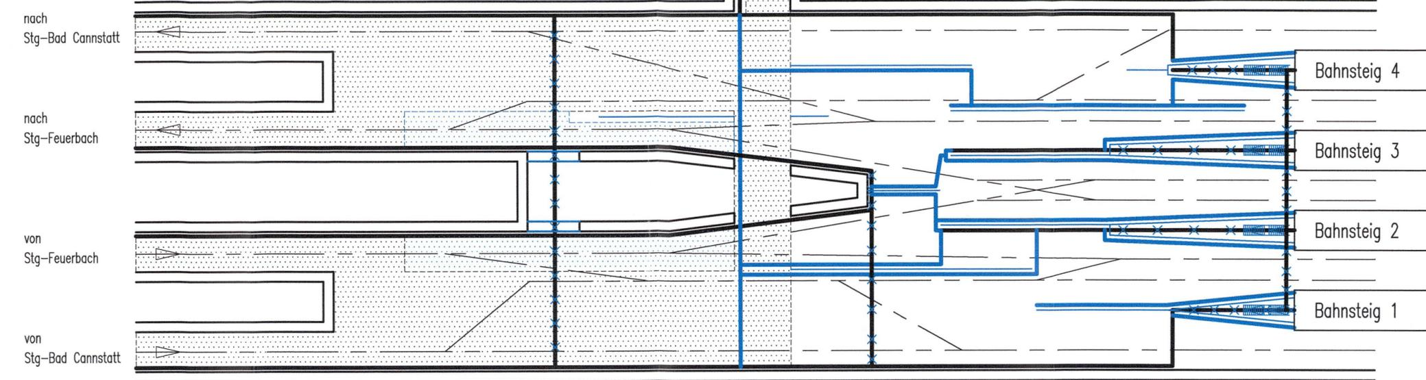
4 eingleisige Tunnel | 2 zweigleisige Tunnel | mehrgleisiger Tunnel Nordkopf (Zwischenwände nicht dargestellt) | Bahnhofshalle
