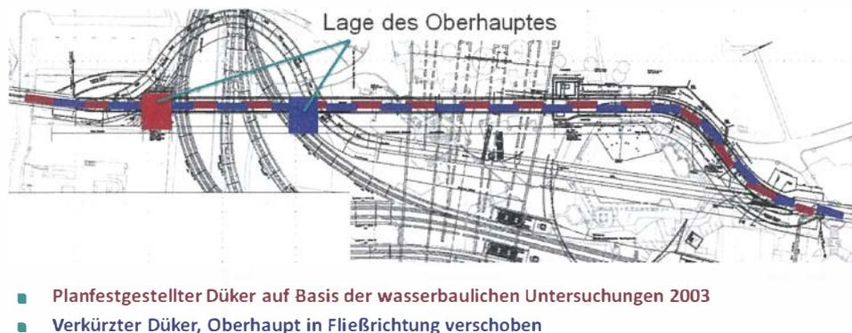
Abbildung 1: Linienführung der beiden Dükervarianten HS Nesenbach
