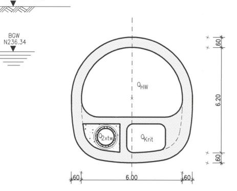
Grundriss nur für Abflußquerschnitte  $Q_{2xtw}$  (DN 1000) und  $Q_{Krit}$
